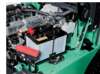
サイドカバーは工具不要で容易に着脱可能。フルオープン式エンジンカバーとあわせて点検作業の時間短縮と作業性向上に寄与します。
