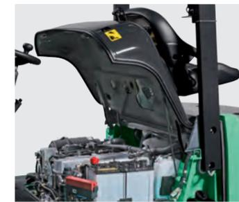
エンジン周りの点検作業を快適に行えるよう、ワンタッチでフルオープンが可能なエンジンカバーを採用。スムーズな点検整備が可能です。
